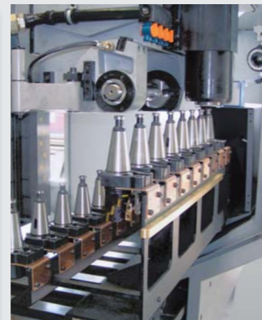
3 Werkzeugmagazin für Vertikalfräskopf
