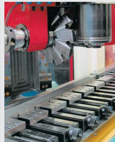
2 Hydraulische Spannvorrichtung, verstellbar von 1 bis 225 mm (360 mm)
