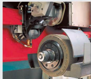
Es können Verzahnungen von Modul 0,1 bis Modul 18, Schnittprofile und alle technisch machbaren Sonderprofile hergestellt werden. Sämtliche Profile sind auch ins Volle schleifbar (Pendel-, Tiefschleifverfahren). Die Schleifscheibe kann der jeweiligen Anforderung, wie Profil, Radius, Form- und Teilungskorrektur angepasst werden. Unsere neu entwickelte spezielle Software erlaubt das parallele Abrichten des Schleifwerkzeuges während der Werkstückbearbeitung.
