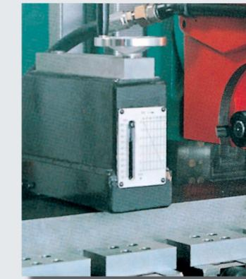
Hydraulische Werkstück-Niederdrückrichtung für Spannhöhen von 10 bis 100 mm.
