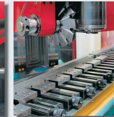
Integrierte hydraulische Spannvorrichtung verknüpft mit der Maschinensteuerung (z. B. Pendelfräsen); verstellbar von 1-225 mm, mit Sonderbacken bis 360 mm. Sonderspannlösungen auf Kundenwunsch.
