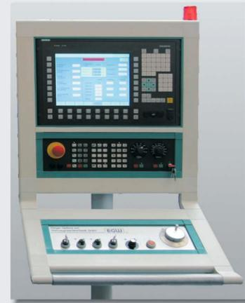
Das schwenkbare Bedienpult ist bedienerfreundlich gestaltet. Einfache Handhabung, schnelle, zeitsparende Programmierung über Menüführung.
