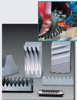
...mit **Standard-Fräskopf** zum Verzahnen von Zahnstangen, Räumnadeln, Sägeblättern, Fräsarbeiten im Längstaktverfahren.
